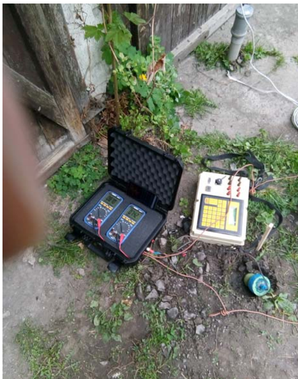
Obr. 3: Měřicí systém BLOW-1. V popředí nepolarizovatelná elektroda.
