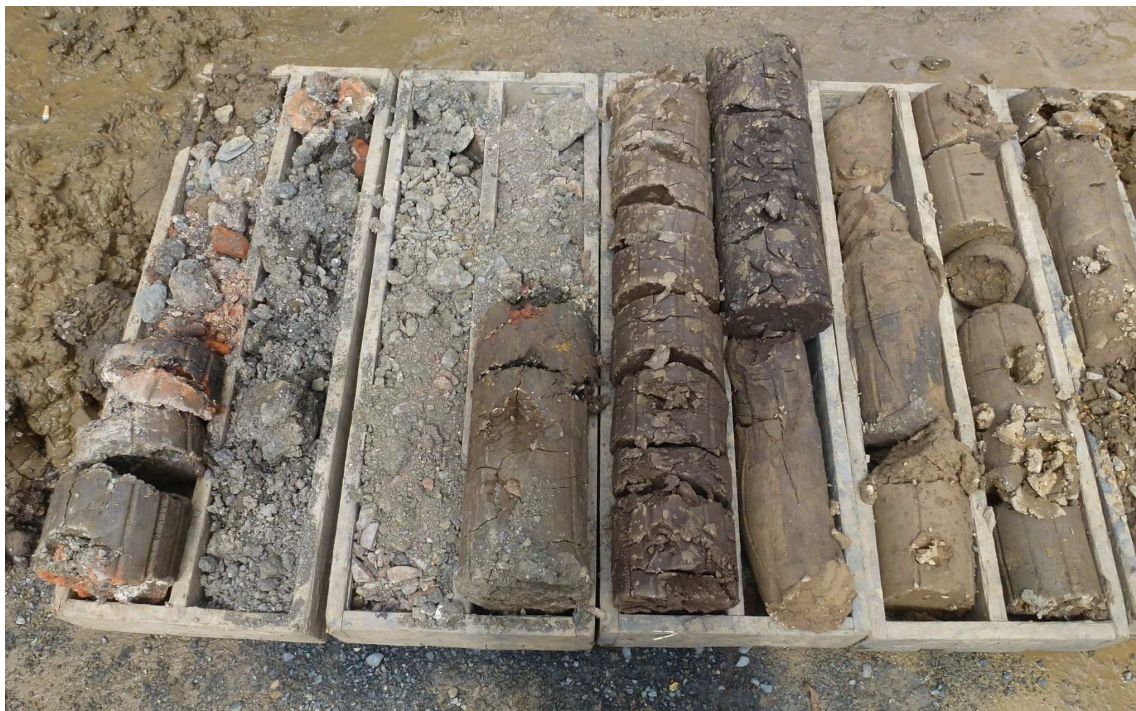
KS 1, vrtné jádro 0 - 8 m
