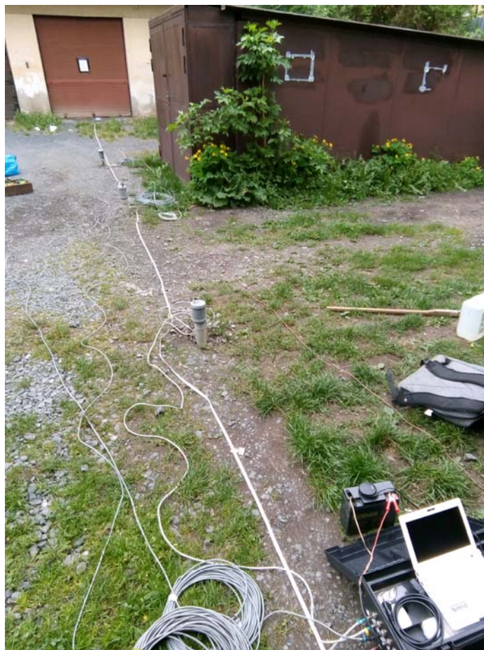
Obr. 5: Seismická aparatura GIA 1 při měření na Starokošířské ulici.
